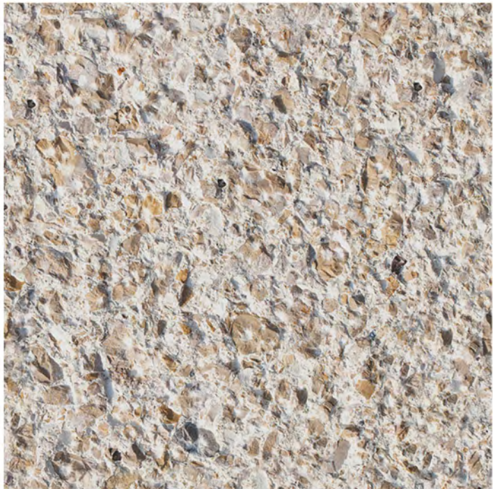
Beispielmuster Beton gestockt
