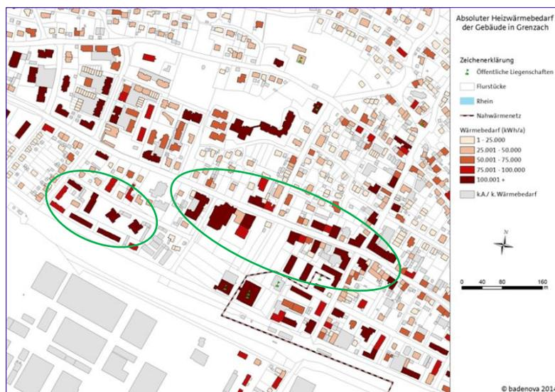
Abbildung: Heizwärmebedarf und Plan des Nahwärmenetzes
