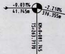
Neigungsbrechpunkte mit Angabe von Gefälle(-) und Steigung in Prozent, Länge der Gefälle-(Steigungs-) Strecke, Station und TS-Höhe mit Halbmesser
