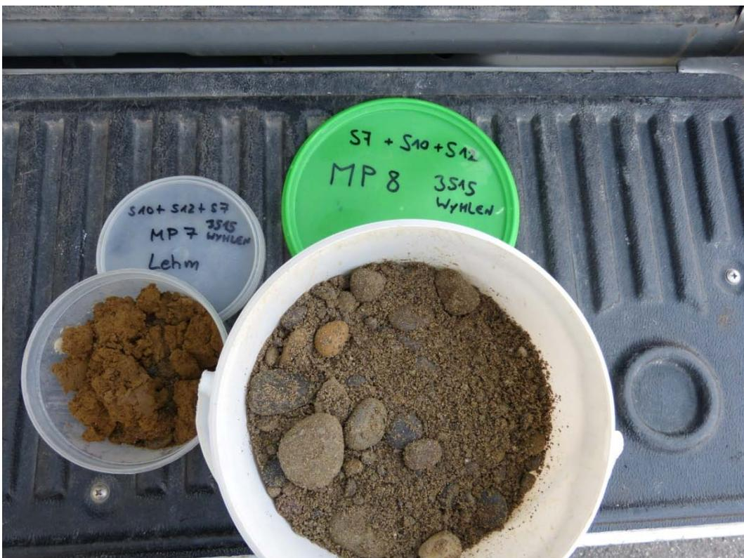
Probenmaterial geotechnische Untersuchungen Probe 2661
