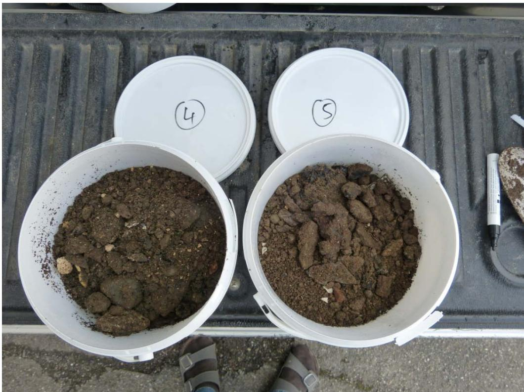
Probenmaterial Baggerschürfe Altablagerung BS 4 und BS 5 Mischprobe 2663
