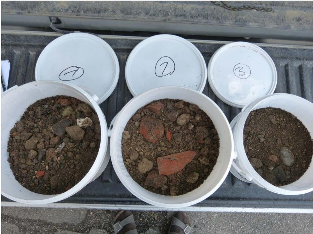
Probenmaterial Baggerschürfe Altablagerung BS 1 bis BS 3 Mischprobe 2662
